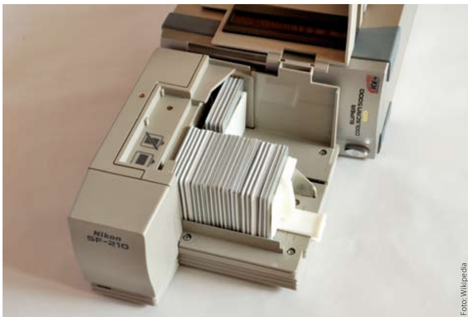
Nikon Coolscan 5000 ED mit Diamagazin SF-210
